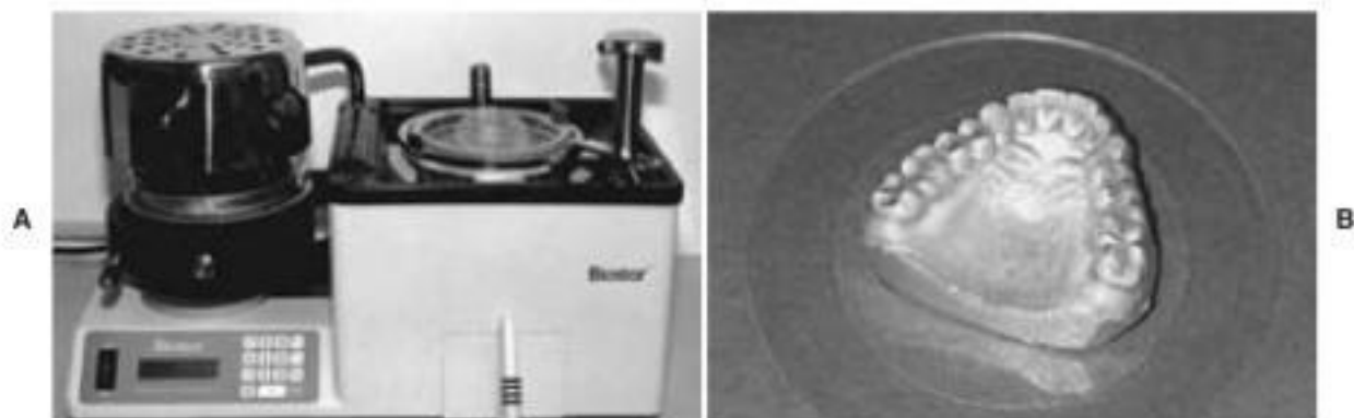
Fig. 15-2 A , Se adapta una lámina de resina transparente de 2 mm de grosor al modelo, con un adaptador de presión Biostar. B , Se puede ver aquí la lámina de resina adaptada al modelo.
