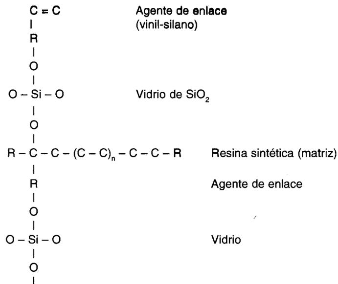
Fig. 7-1. Uniones químicas entre los distintos componentes de una resina reforzada.
