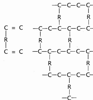
Fig. 5-10. Formación por adición de un polímero de cadenas cruzadas. (No se muestran los hidrógenos u otros grupos unidos al carbono.)
