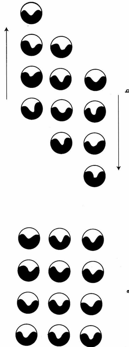
Fig. 4-18. Distribución de iones (a) y deformación bajo carga (b) en un grano cristalino.
