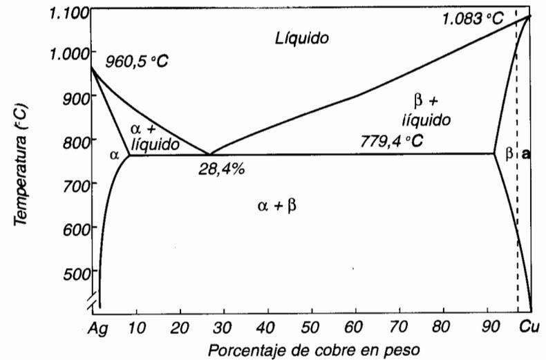
Fig. 4-14. Diagrama de equilibrio del sistema plata-cobre.
