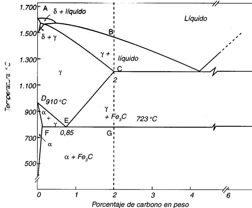
Fig. 4-17. Diagrama de equilibrio del sistema hierro-carbono.
