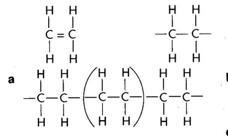
Fig. 5-8. Molécula de etileno (a); la misma molécula activada (b) y molécula de poli(etileno) (c).
