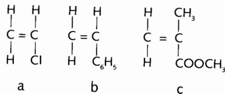
Fig. 5-9. Monómero de cloruro de vinilo (a), vinil benceno o estireno (b) y 2-metil propenoato de metilo o metacrilato de metilo (c).
