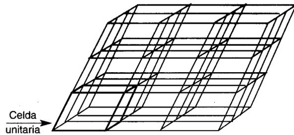
Fig. 1-8. Reticulado espacial (esquemático) con celda unitaria resaltada.
