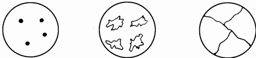
Fig. 4-4. Esquema del proceso de solidificación de un metal.
