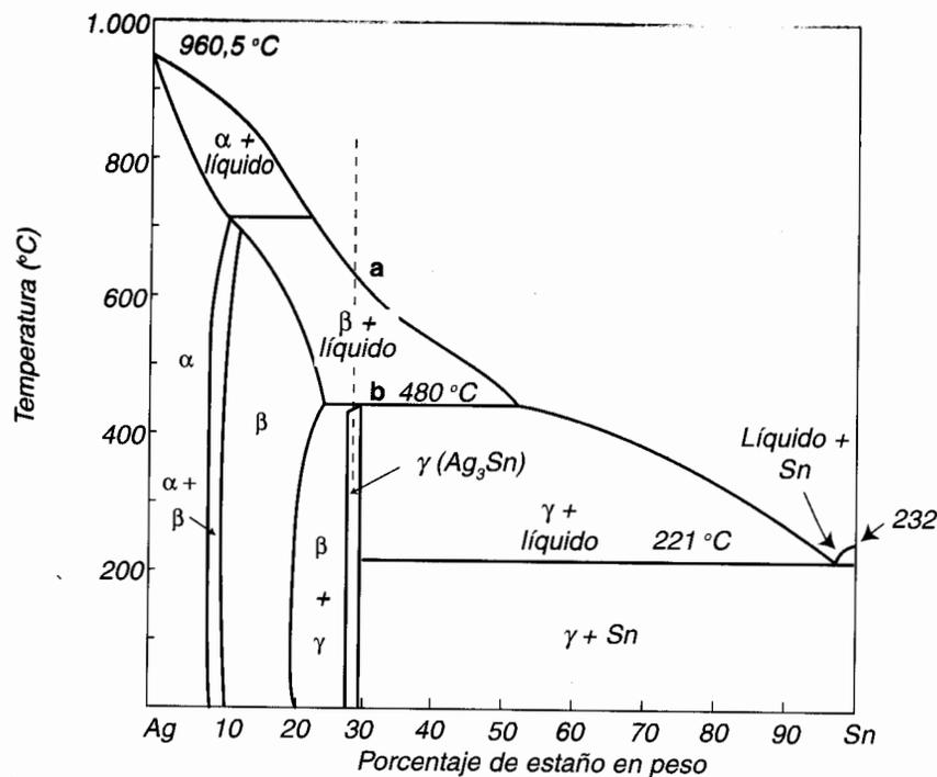
Fig. 4-15. Diagrama de equilibrio del sistema plata-estaño.
