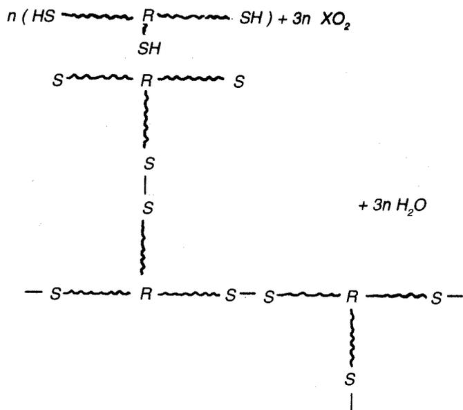
Fig. 5-6. Esquema de la formación por condensación de un polímero de cadenas cruzadas.
