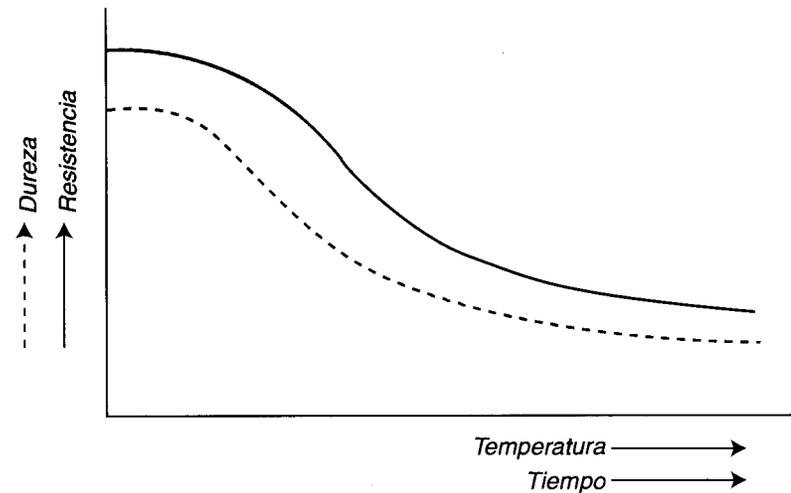
**Fig. 4-23.** Efecto de la temperatura y/o el tiempo sobre las propiedades mecánicas de una estructura metálica labrada.
