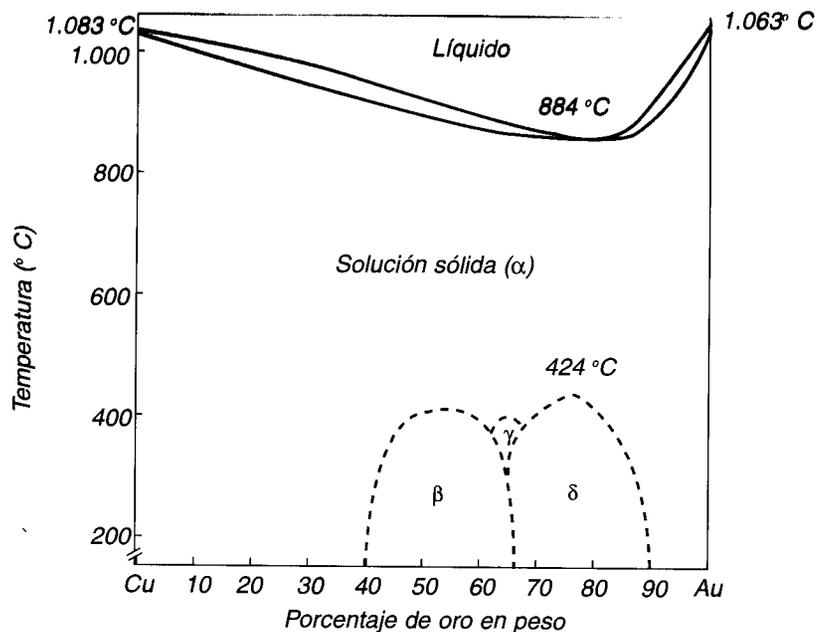
Fig. 4-16. Diagrama de equilibrio del sistema cobre-oro.
