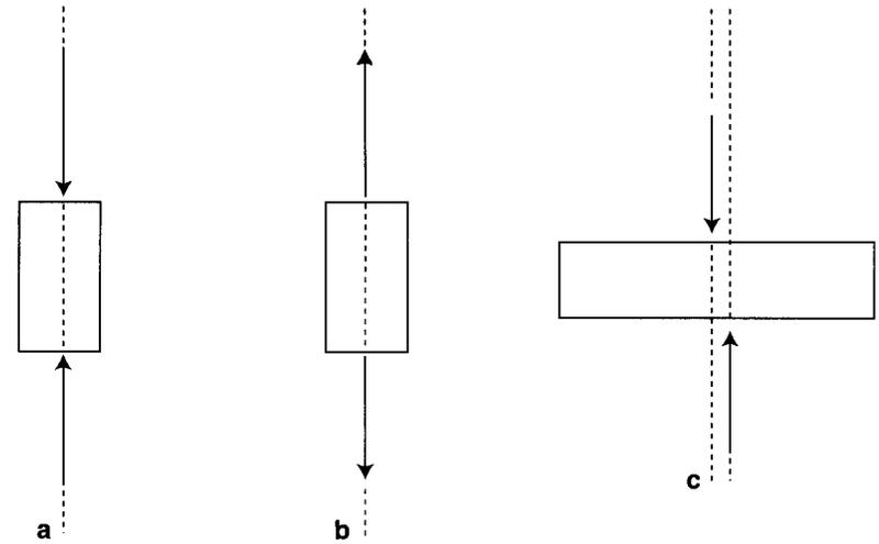
**Fig. 2-1.** Pares de fuerzas que inducen tensiones compresivas (a), traccionales (b) y tangenciales o de corte (c).
