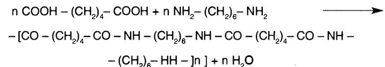
Fig. 5-5. Formación de un polímero por condensación entre el ácido hexanodioico y la hexanodiamina.
