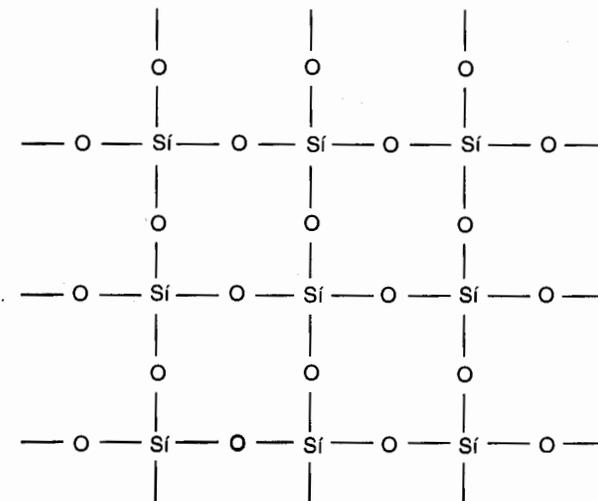
Fig. 1-5. Esquema de la estructura en materia sólida con uniones covalentes.
