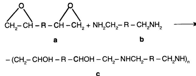
Fig. 5-7. Formación de un polímero epóxico por apertura de anillos.
