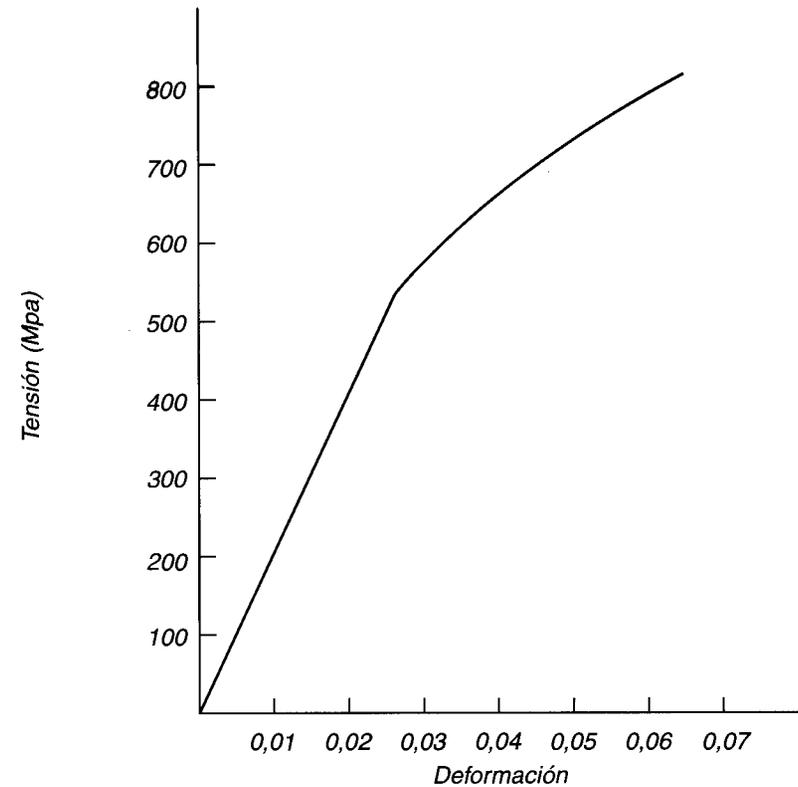
**Fig. 2-4. Gráfico tensión/deformación.**
