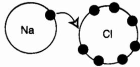
Fig. 1-2. Esquema de la unión iónica o electrovalente. Sólo se muestra la capa externa de electrones.
