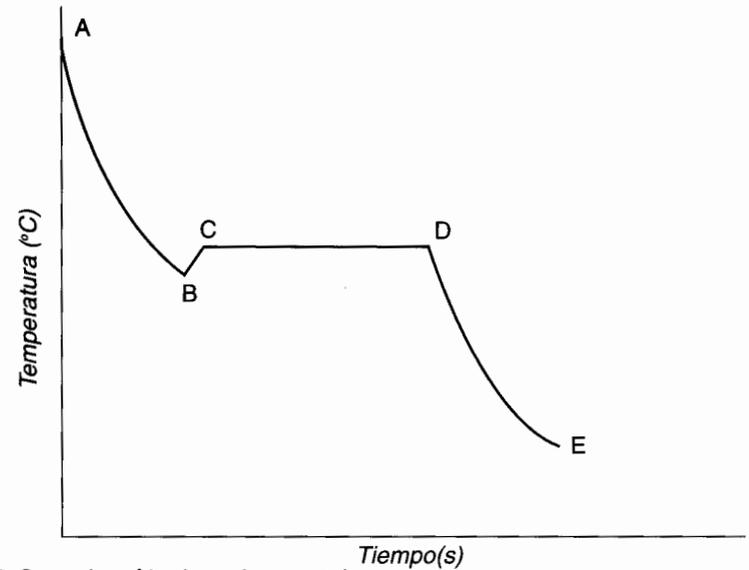
Fig. 4-5. Curva de enfriamiento de un metal.
