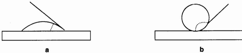
Fig. 3-3. Gota de líquido sobre la superficie de un sólido mojándolo (a) y no mojándolo (b).
