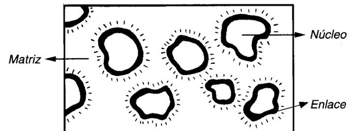
Fig. 7-2. Esquema de la estructura de una resina reforzada.
