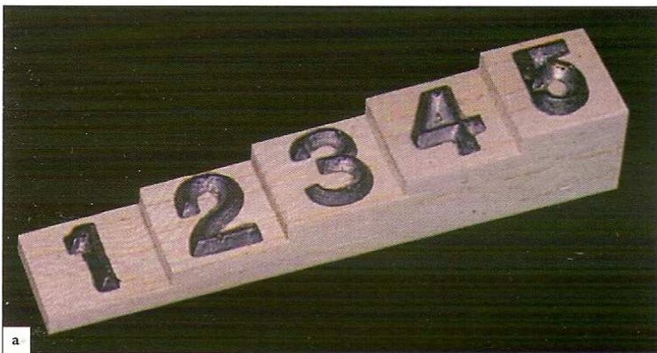
Figura 16.13. Ilustración de un efecto tomográfico. (a) Secuencia de diferentes escalones de plomo. (b) Radiograma convencional representando las diferentes figuras con igual dureza. (c) Tomografía con el centro de rotación localizado al nivel del número 3. Las figuras posicionadas fuera del centro están proyectadas en diferentes puntos en la película, y por ello aparecerán progresivamente más borrosas con el aumento de la distancia del centro de rotación. (d) Cuando las figuras están localizadas en los mismos niveles, como en (a), pero una sobre otra, están superimpuestas. La capa enfocada, por ejemplo la número 3, es detectada, aunque la representación de las figuras a los lados del centro deja una imagen borrosa.
