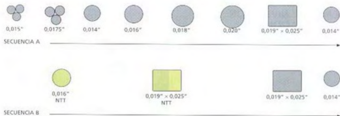
Fig. 5.34 En algunos casos los autores siguen la secuencia B para completar un caso. Proporciona una mecánica muy eficiente y pocos cambios de arco. Sin embargo, en muchos tratamientos es necesario utilizar algunos de los alambres de la secuencia tradicional A. Esto se expone más abajo.
