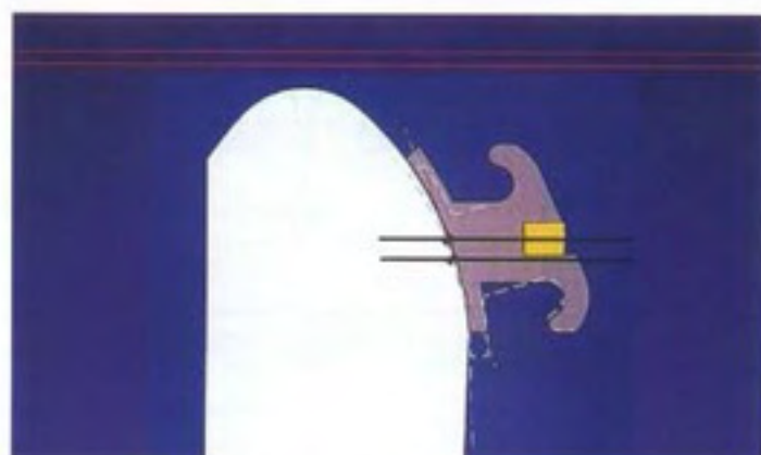
Fig. 2.8 El resultado del sistema CAD es que la bracket resultante puede tener el torque en la base, en la cara o una combinación de ambos.
