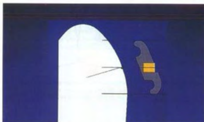
Fig. 2.7 El sistema CAD analiza la ubicación ideal de la ranura y diseña la bracket alrededor de la misma.
