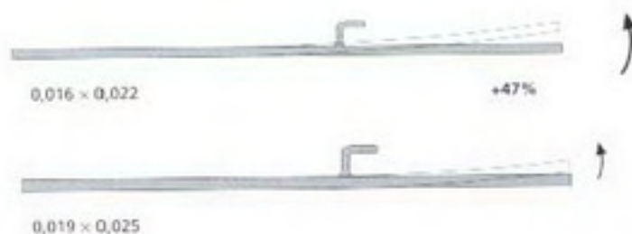
Fig. 1.22 Los arcos de trabajo de 0,019" \times 0,025" son más rígidos que los de 0,016" \times 0,022" o 0,017" \times 0,025" y se comportan mejor durante el cierre de espacios y el control de la sobremordida.
