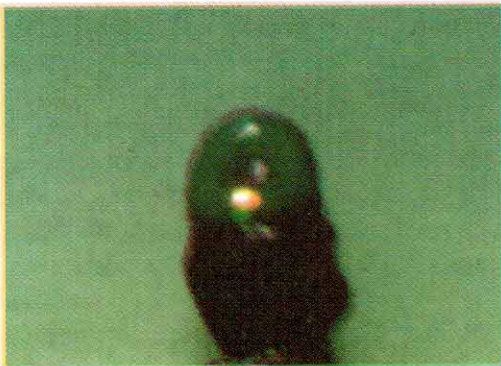
Fig. 8-3. La fuente lumínica emite tres puntos luminosos correspondientes a cada uno de los planos del espacio.
